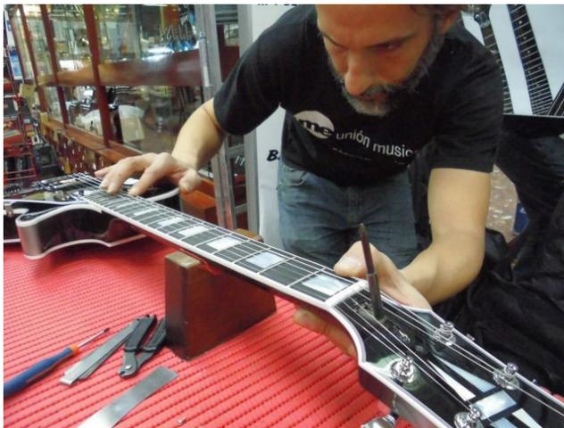
Para comprobar la curvatura del mástil ejercemos presión sobre el traste 1 y el último de nuestro instrumento y en la zona central sobre los trastes 7 y 9 observaremos que la cuerda quedará levantada varios
