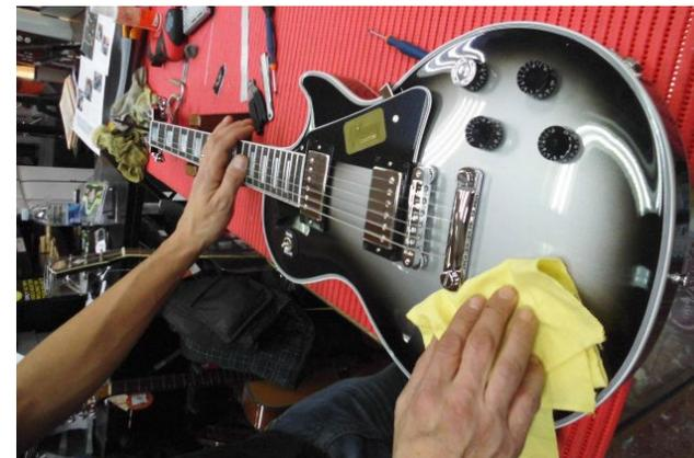
Y por fin el último paso, el ajuste de la altura de las pastillas respecto a la posición de las cuerdas, situándolas entre 2 mm en la primera cuerda y 3 mm en la cuarta tendremos un ajuste estándar que nos asegura un correcto funcionamiento de las pastillas.
