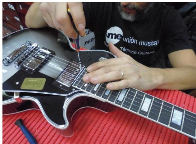
En el instrumento que estamos ajustando nos encontramos con que no tiene el clásico puente de silletas independientes para cada cuerda, sino que tiene un puente fijo en el que la altura de las cuerdas ya vienen definidas conforme al radio del diapasón. Y mediante dos puntos situados uno a cada lado del puente nos permite regular su altura sobre el mástil.
