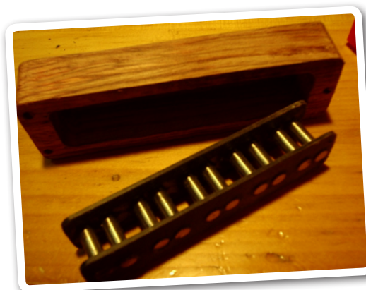
■ Pastilla para bajo en construcción.
