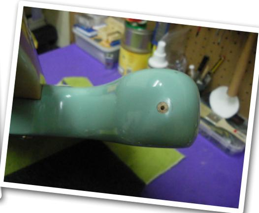
Una vez este seco, taladraremos con la broca de 2mm en el centro de la varilla que hemos incrustado, de esta manera volveremos a tener la cavidad "rellena" y adaptada a la medida de los nuevos tornillos de los enganches de seguridad que vamos a instalar.
