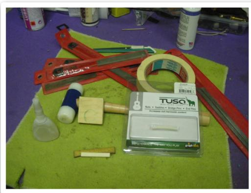
En este caso será un hueso, pero se puede utilizar ébano, latón y compuestos sintéticos con muy buenos resultados, la marca Tusq tiene un amplio catálogo donde poder seleccionar lo que prefiramos. Un hueso de xxx, un juego de limas del calibre de las cuerdas: 0,45-1,05, limas planas, lija auto adhesiva, lápiz, un juego de galgas, pasta de grafito, un cúter, cinta de carroceros, martillo y un taco de madera.
