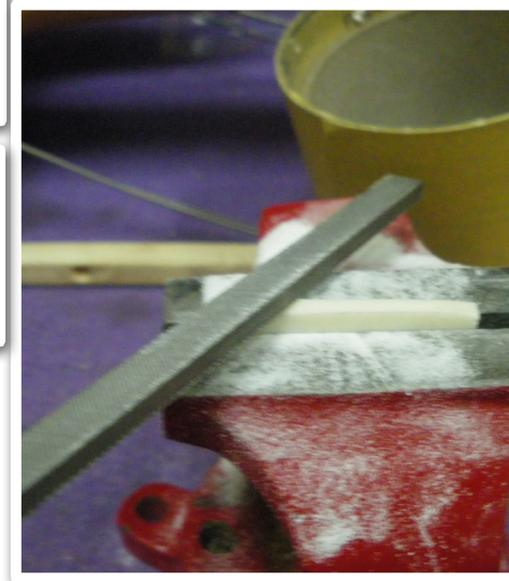
Marcaremos las ranuras con un rotulador, lima, marcador etc... (En este caso la cejuela tiene un largo de 38,5mm y una separación de cuerdas de xxx)
