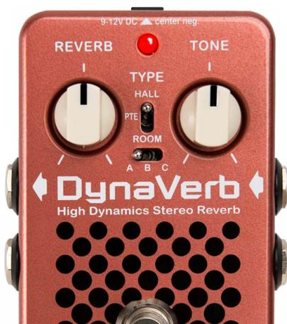
ROOM y PLATE se pueden ejecutar en tres variantes A, B y C mientras que HALL ofrece dos variantes A, B (aquí C es igual a B). Todas estas combinaciones hacen un total de 8 reverbs diferentes. Los controles simplemente ajustan el volumen para el efecto y la cantidad de reverb para mezclar.
