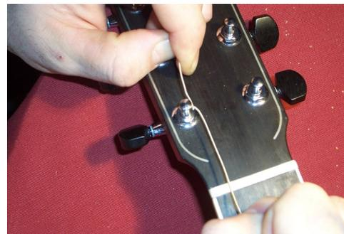
6.-Damos el resto de vueltas por debajo de la salida del sobrante. Podemos apreciar como la cuerda queda auto aprisionada por sí misma, de ahí que quede "mirando" hacia arriba.
