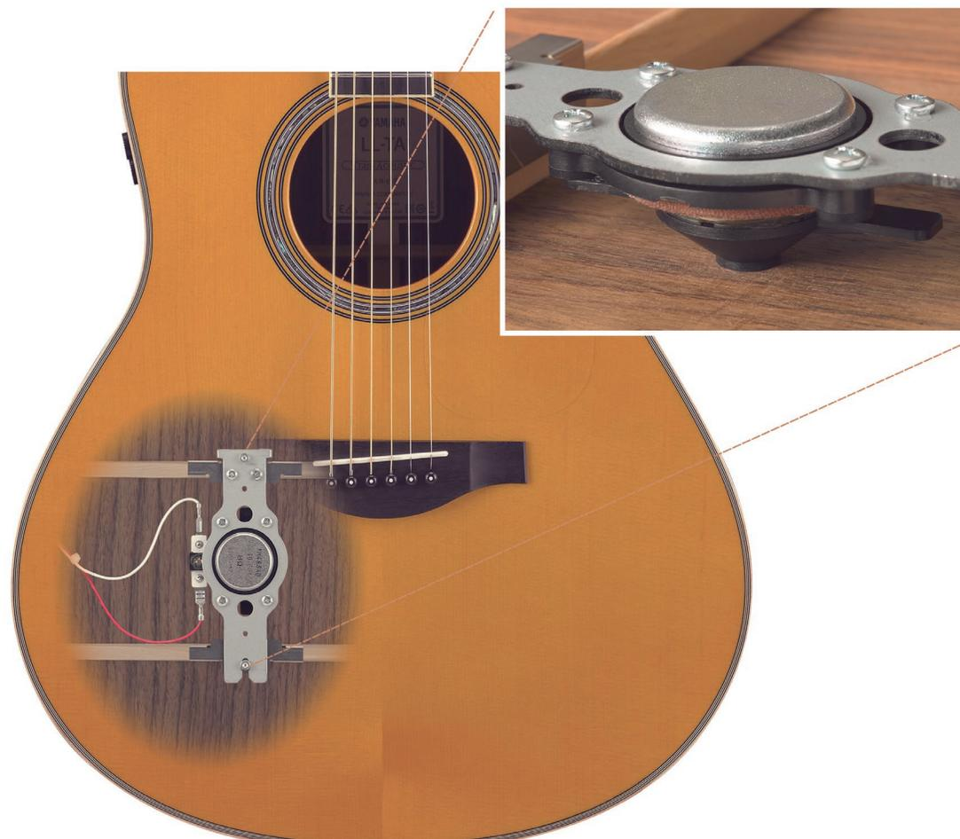
detecta las vibraciones de la cuerda, las amplifica y procesa, transfiriéndolas al cuerpo para producir reverb y chorus acústicamente dentro de la cámara de sonido.
