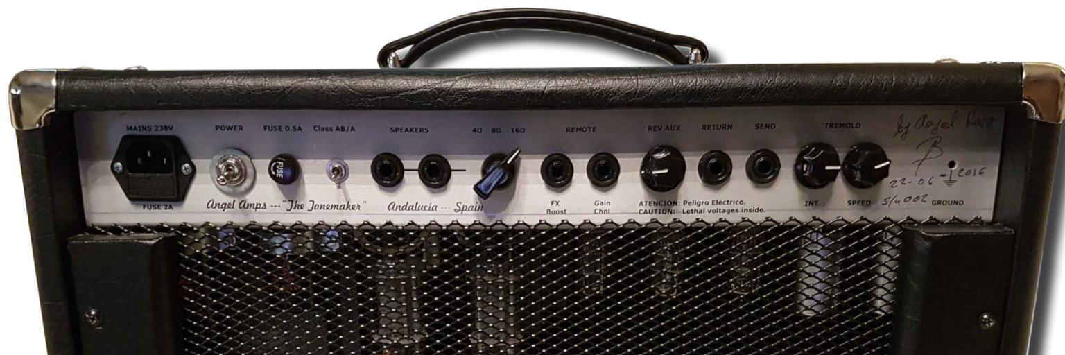
“...el peor escenario de seguridad que podría darse sería olvidarse de conectar el altavoz a cualquiera de las salidas y hacer funcionar el amplificador en vacío. Para ese caso, este amplificador incorpora una configuración de seguridad que evita daños en el mismo hasta que nos diéramos cuenta del error...”
