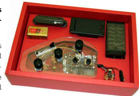
Fernández FSK 101, lleva el circuito sustainer y los cables con sus conectores, driver en formato humbucker, cafetín de la pila, jack de salida y la pila. Este kit sólo tiene dos modos de funcionamiento, el normal y el modo mix, tampoco incorpora control de intensidad del sustain.
