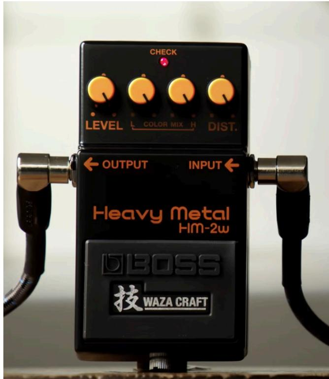
el modo S sería el standard del HM-2 original con un noise floor más bajo y una salida adicional de 3dB en comparación con el original y el C sería el custom que cambia parte de la tonalidad para brindarle más ganancia, más claridad y ese más de ese tono motosierra tan relevante en el pedal.
