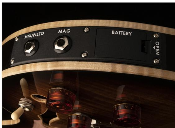
ejecutar pastillas magnéticas en un amplificador y el piezo a través de un amplificador acústico o DI. Cuando se usa el conector de salida magnética de forma aislada, la batería piezoeléctrica se deriva por completo, actuando como un dispositivo a prueba de fallos (en este escenario, las pastillas magnéticas aún funcionan incluso si la batería piezoeléctrica se ha agotado).
