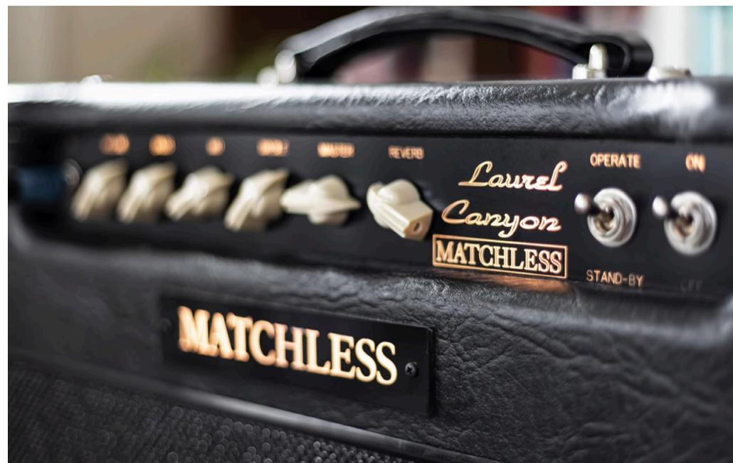
Como un buen amplificador de boutique presenta un cableado soldado punto a punto, un chasis de acero y un cabinet de madera contrachapada de abedul Báltico.
