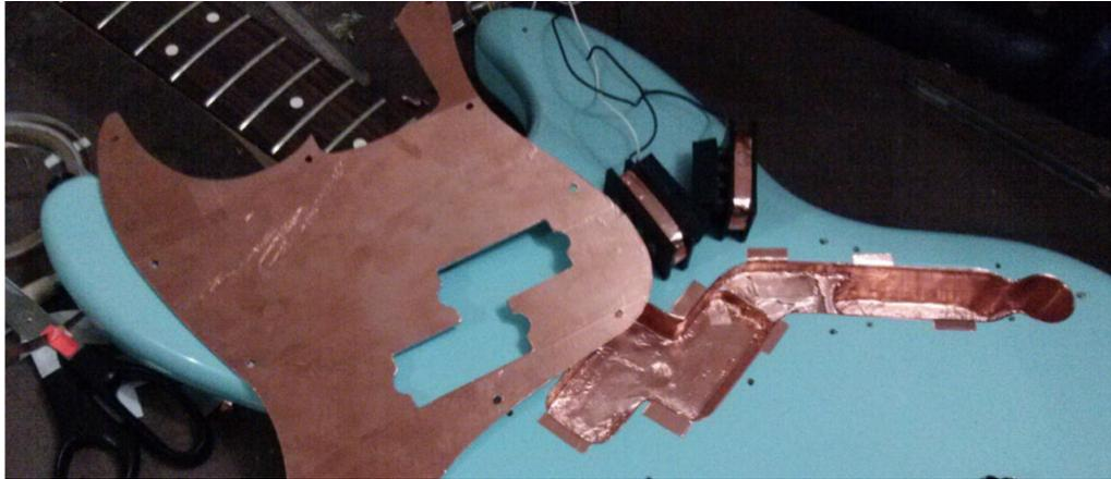
señal obtenida. También debemos comprobar si tenemos un buen aislamiento en cabezales o pedales de efectos por ejemplo para evitar bucles de ruido de masa y por encima de todo tener una instalación eléctrica en casa con un buen aislamiento y una toma a tierra general. Si conseguimos que todos estos pequeños componentes y dispositivos estén bien aislados la reducción de ruidos y la posibilidad de que se den será mínima. Recordad que cada eslabón de la cadena cuenta.
