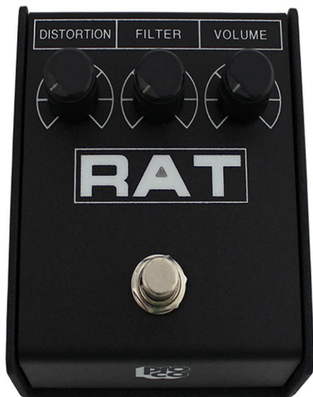
muy amplio. La distorsión de la señal se genera a través de dos diodos entre la señal y la masa situados entre la etapa de “drive” y la de filtrado. Para ello, el Rat emplea 2 diodos de silicio 1N4148.
