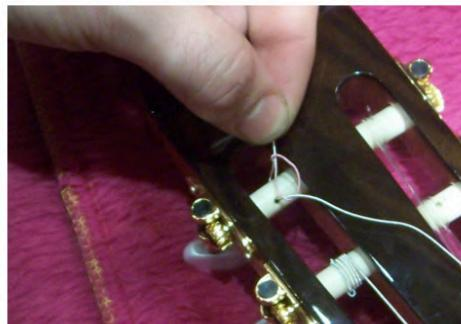
4.- tensamos el sobrante para que se cierre el nudo y giramos la clavija.
